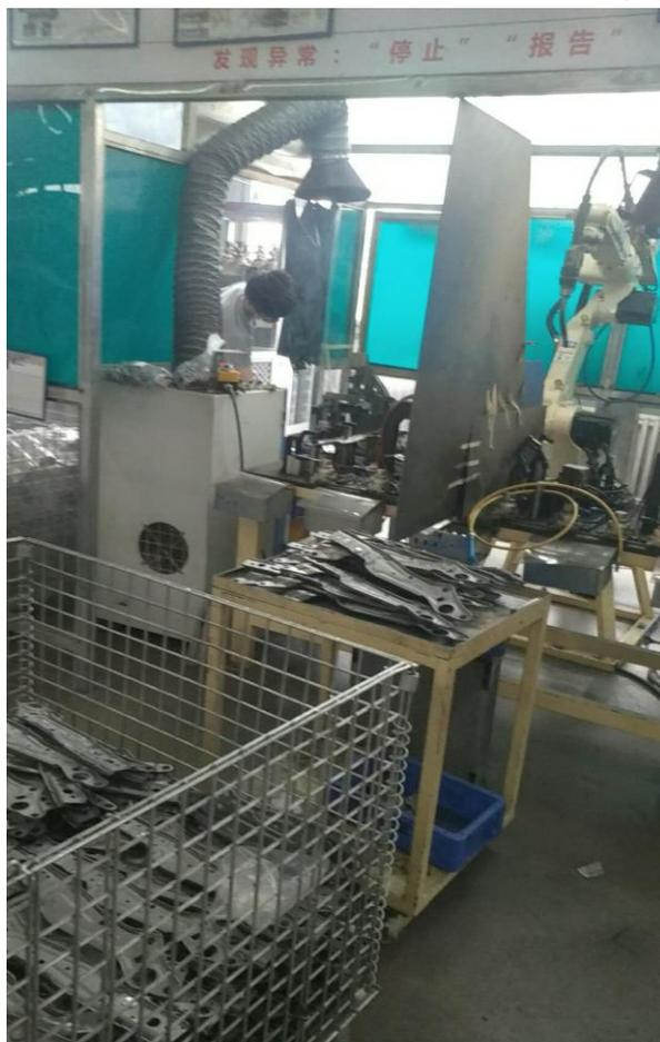
移动式焊接烟尘净化器
