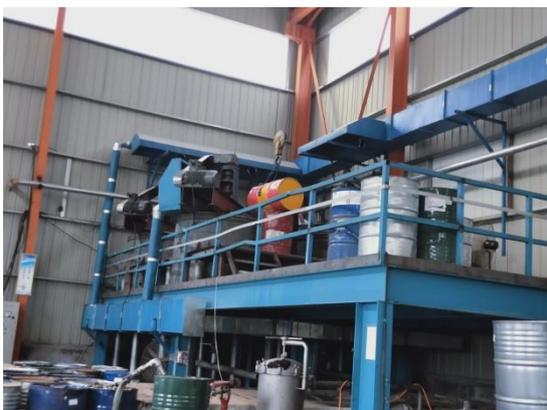
图 3-1 冷调车间集气罩现场照片
